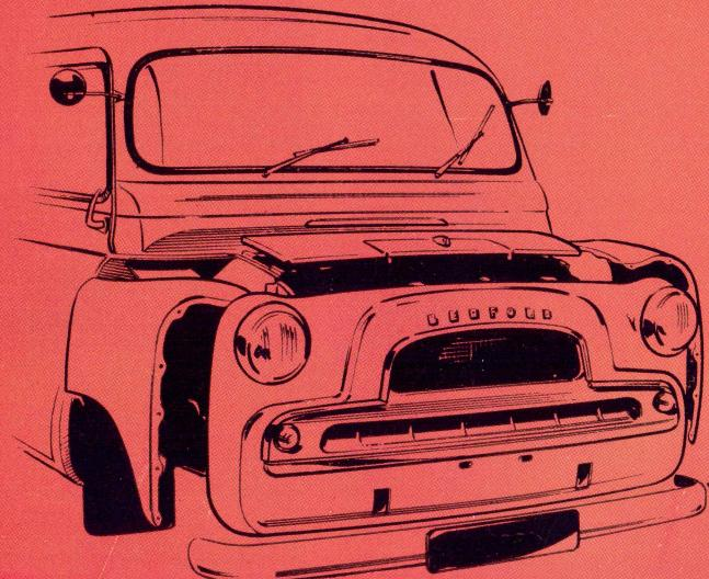
**Motor:** 4-cylindret, topventilet, med aftageligt topskykke. Boring 79,4 mm, slaglængde 76,2 mm, cylindervolumen 1508 cm<sup>3</sup>, kompressionsforhold 7,8:1. Maks. HK 55 ved 4200 omdr./min. Maks. drejningsmoment 11,7 kgm ved 2400 omdr./min. Gearkassen sammenbygget med motoren. Hele aggregatet er 3-punktsophængt med gummi-isolering for og bag. Ovalslebne letvægtsstempler af aluminium-legering med tinplateering.
