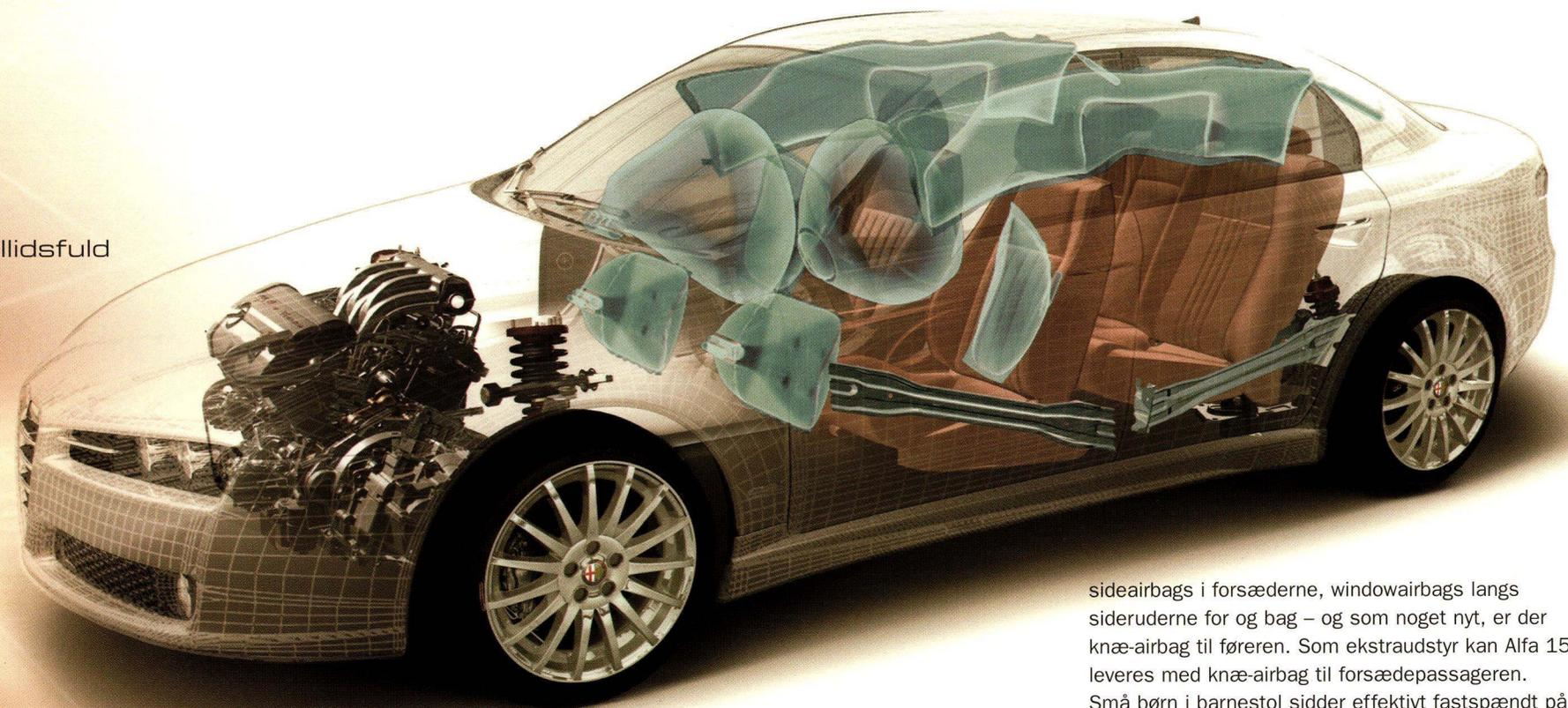
sideairbags i forsæderne, windowairbags langs sideruderne for og bag – og som noget nyt, er der knæ-airbag til føreren. Som ekstraudstyr kan Alfa 159 leveres med knæ-airbag til forsædepassageren. Små børn i barnestol sidder effektivt fastspændt på bagsædet ved hjælp af to Isofix beslag. I Alfa 159 kan man rejse med ro i sindet.
