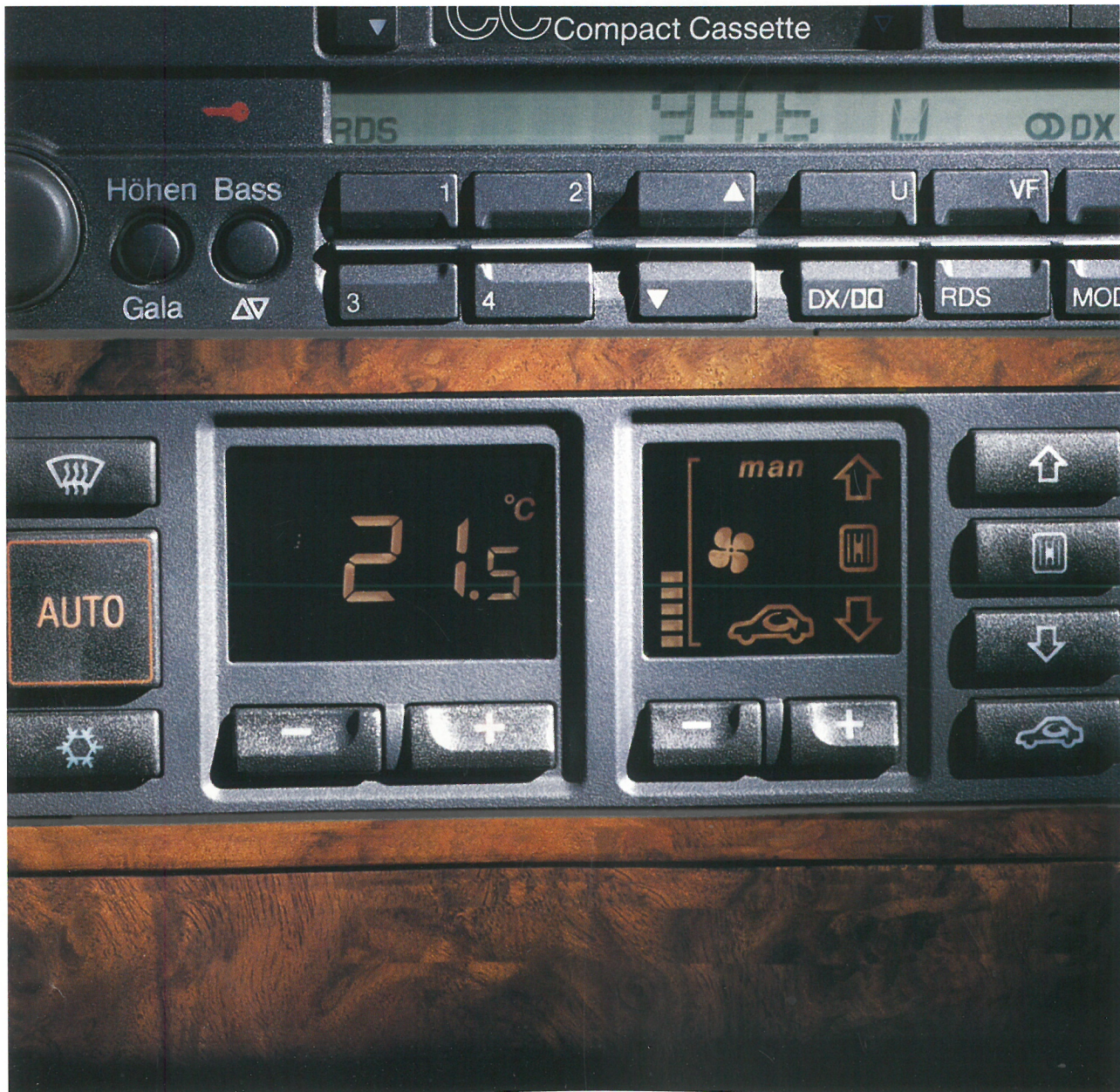
Ekstra-udstyr: Klimaanlæg med automatisk regu- lering (fås fra 2.0E). Kølemiddel uden CFC-gasser
