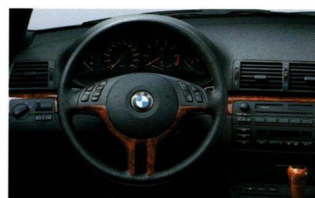
**Multifunktion für Lenkrad**, für Geschwindigkeitsregelung und Fernbedienung für Radio bzw. Telefon – hier abgebildet Sport-Lederlenkrad, drei Speichen, inkl. Lenkradspange und Schalthebelknopf in Edelholz Ahorn Hochglanz ausgeführt.
