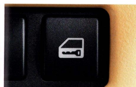
■ **Center-Lock-Schalter** zum Betätigen der Zentralverriegelung vom Innenraum aus.
