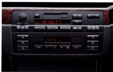
□ **BMW Reverse**, 4 x 10 Watt Verstärkerleistung, UKW-, MW-, LW-Empfang, insgesamt 6 Stationstasten, Loudness-Funktion und geschwindigkeitsabhängige Lautstärkeregelung; Cassettenteil u. a. mit Autoreverse und automatischer Bandsortenerkennung.
