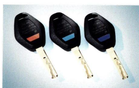
■ **Car/Key Memory**: Mit Car Memory lässt sich z. B. am Fahrzeug programmieren, dass das Abblendlicht beim Start automatisch aktiviert wird; mit Key Memory kann z. B. die gewohnte Einstellung des elektrischen Sitzes auf den Schlüssel jedes Fahrers (bis zu vier Schlüssel) codiert und beim Öffnen der Zentralverriegelung aktiviert werden.
