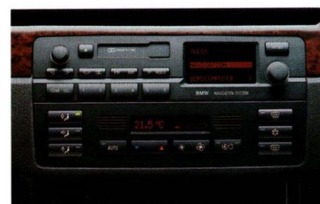
□ **Radionavigation** mit monochromem, ins Radiobedienteil (BMW Radio Business) integriertem LC-Display; Verkehrsführung erfolgt ausschließlich über Sprachhinweise und Pfeildarstellungen auf dem Display.
