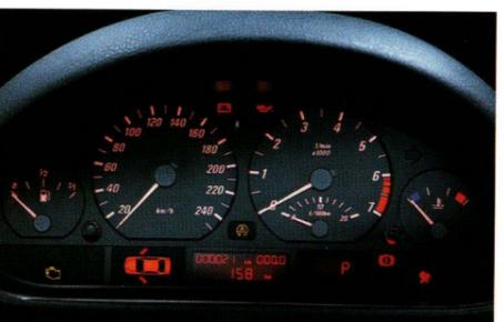
■ **Instrumententafel** mit Analoginstrumenten und roter Durchlichtbeleuchtung, Drehzahlmesser mit Energie-Control, Tankuhr, Kühlmittelthermometer, LC-Display für Kilometer- und Tageskilometerzähler, Digitaluhr und Check-Control.
