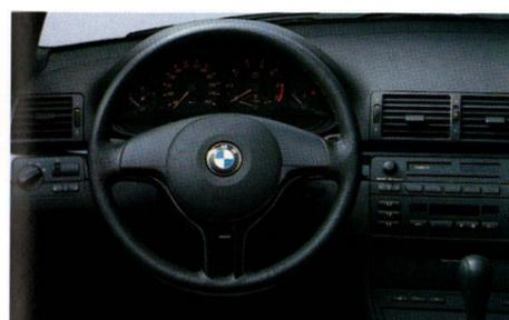
**Sport-Lederlenkrad** (Durchmesser 375 mm), drei Speichen, Lenkradspange in Farbe der Interieurleisten – hier Schwarz Hochglanz –; inkl. Schalthebelknopf bzw. Wählhebelgriff in Leder bzw. Edelholz ausgeführt.
