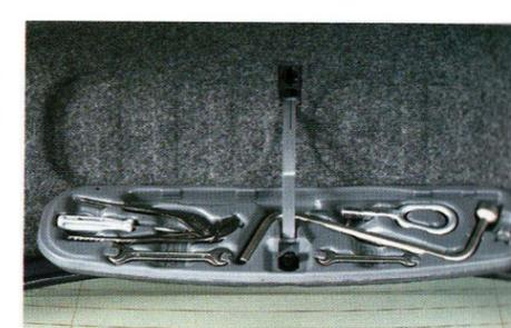
■ **BMW Werkzeug**: umfangreiches Werkzeugset, in einer Box an der Innenseite der Gepäckraumklappe untergebracht.
