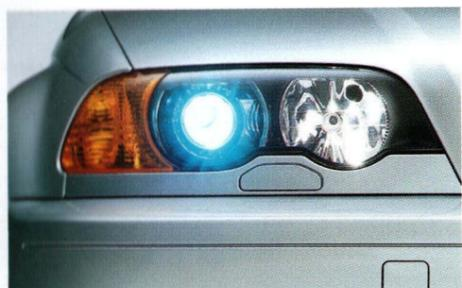
□ **Xenon-Licht**, inkl. dynamischer Leuchtweitenregulierung, ermöglicht eine deutlich bessere Fahrbahnausleuchtung bei schlechter Witterung oder Sicht – die Leuchtkraft ist mehr als doppelt so hoch wie bei herkömmlichen Halogenlampen (nur in Verbindung mit Scheinwerfer-Reinigungsanlage erhältlich).
