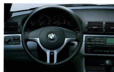
**Sport-Lederlenkrad** (Durchmesser 375 mm), drei Speichen, Lenkradspange in Farbe der Interieurleisten – hier Grau Hochglanz –; inklusive Schalthebelknopf bzw. Wählhebelgriff in Leder bzw. Edelholz ausgeführt.
