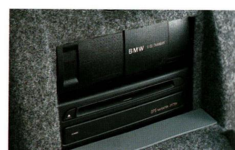
□ **CD-Wechsler**, in den Gepäckraum integriert. Der CD-Wechsler mit exzellentem Klangniveau kann bis zu sechs CDs aufnehmen.
