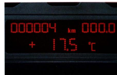
□ **Bordcomputer** informiert über Durchschnittsgeschwindigkeit, Durchschnittsverbrauch, Reichweite und Außentemperatur (Serie für alle Sechszylinder).
