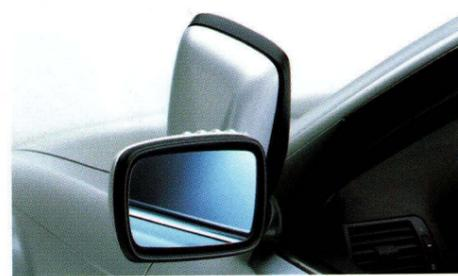
□ **Außenspiegelpaket**: Fahrer- und Beifahrer- Außenspiegel beheizt; durch die integrierte Anklappfunktion lassen sich beide Außenspiegel elektrisch anklappen (z. B. in der Waschstraße) und auf Knopfdruck wieder zurückklappen.
