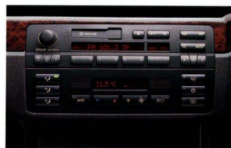
□ **BMW Business**, 4 x 20 Watt Verstärkerleistung, Antennen-Diversity (drei in die Heckscheibe integrierte Antennen übertragen das UKW-Radiosignal bestmöglich), Dolby B/C, schaltbare Loudness-Funktion, integriertes Cassettenteil, Anschluss für BMW CD-Wechsler.
