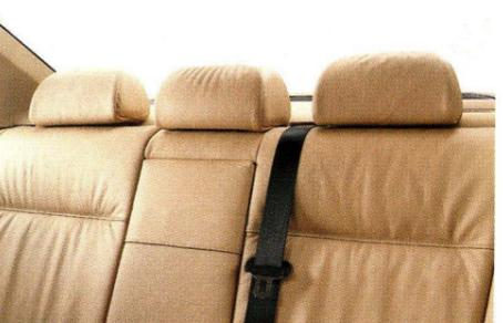
**Kopfstützen im Fond:** zwei manuell höhenverstellbare Kopfstützen (dritte Kopfstütze für alle Modelle als Sonderausstattung erhältlich).
