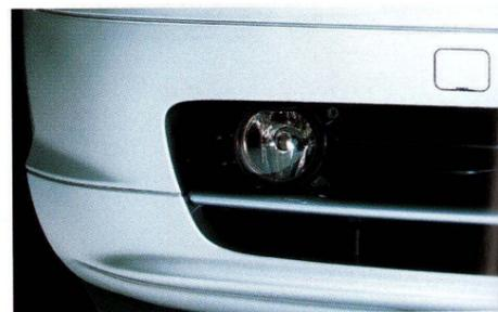
□ **Nebelscheinwerfer**, rund, in die Frontschürze integriert, für mehr Sicherheit bei schlechten Sichtverhältnissen (Serie für alle Sechszylinder).
