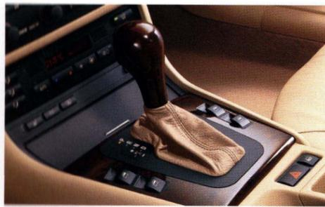
□ **5-Gang-EH-Automatic** mit Steptronic, Adaptiver Getriebesteuerung (AGS), Shift-/Interlock; mit der Steptronic lässt sich das Automatikgetriebe wahlweise auch wie ein Schaltgetriebe nutzen (ohne zu kuppeln), für 318Ci als 4-Gang-EH-Automatic erhältlich, gleicher Funktionsumfang.
