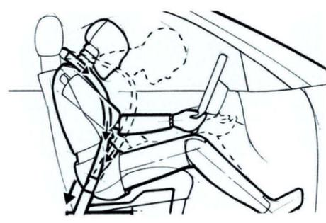
■ **BMW Rückhaltesystem** für Fahrer und Beifahrer, Kombination aus 3-Punkt-Sicherheitsgurt, Gurtstrammer, Gurtkraftbegrenzer und Submarining-Stütze im Sitz, sorgt für bestmögliche Rückhaltewirkung bei einer Kollision.
