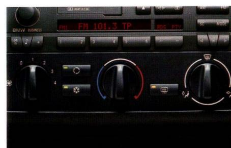
□ **Klimaanlage**, inkl. Mikrofilter, sorgt für komfortables Innenraumklima zu jeder Jahreszeit; Luftmengenregelung und Luftverteilung manuell einstellbar (Serie für alle Sechszylinder).
