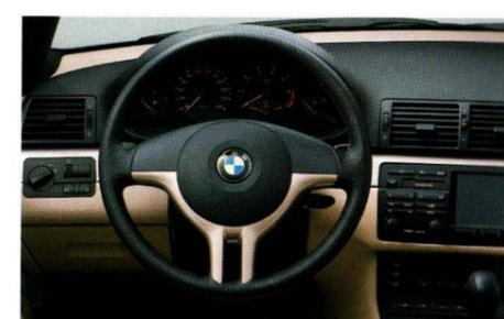
**Sport-Lederlenkrad** (Durchmesser 375 mm), drei Speichen, Lenkradspange in Farbe der Interieurleisten – hier Beige Hochglanz –; inkl. Schalthebelknopf bzw. Wählhebelgriff in Leder bzw. Edelholz ausgeführt.
