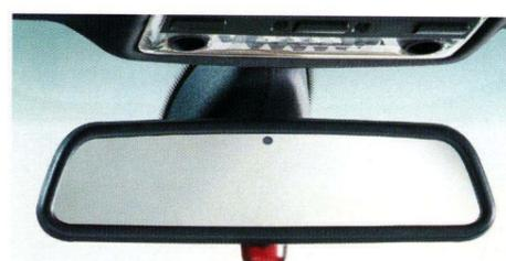
□ **Innenspiegel** automatisch abblendend, große Spiegelfläche; ab einem definierten Lichteinfall durch nachfolgende Fahrzeuge blendet der Spiegel automatisch ab.
