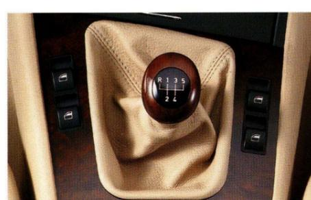
**Fensterheber vorn elektrisch**, Mautfunktion „Auf-Zu“, Einklemmschutz und Komfortschließung an beiden Türen; zusätzlich elektrische Ausstellfenster hinten; Komfortschaltung „Auf“ für beide Seiten; automatische Absenkung der Fahrertürscheibe zur Einstiegserleichterung (nur über Funktion Car/Key Memory).
