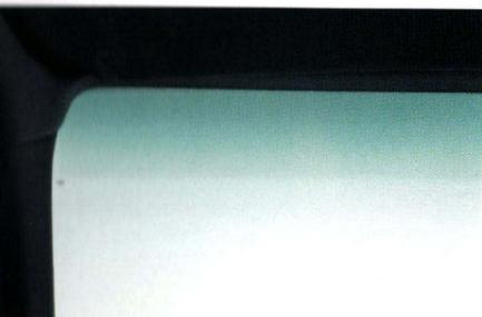
**Klimakomfort-Frontscheibe** reduziert die unangenehme Aufheizung des Innenraums mittels einer Infrarotlicht reflektierenden Schicht; der Krümmung am oberen Scheibenrand verhindert die direkte Blendung durch die Sonne.
