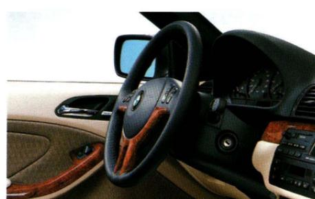
**Servolenkung:** Hydraulische Lenkhilfe zur Unterstützung beim Parken und Rangieren; durch die Crash-optimierte Sicherheitslenksäule wird das Lenkrad bei einer Frontalkollision vom Fahrer weg bewegt.
