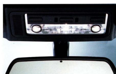
**Innenleuchten:** Innenlichtautomatik mit „weicher“ Ein-/Aus-Schaltung beim Öffnen/Schließen des Fahrzeugs, Auflichtbeleuchtung der Mittelkonsole.
