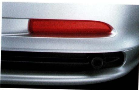
■ **Heckreflektoren** in Rot setzen optische Akzente und sorgen gerade bei nächtlichen Fahrten für noch mehr Sicherheit (bessere Wahrnehmung des Fahrzeugs durch andere Verkehrsteilnehmer).
