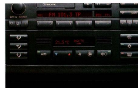
□ **Klimaautomatik**, inkl. AUC und Solarsensor, sorgt schnellstmöglich für Ihr Wunschklima im Innenraum und hält eine vorgewählte Temperatur konstant; mit der integrierten Automatischen Umluft Control (AUC) gelangen Schadstoffe aus der Luft ab einer bestimmten Konzentration nicht mehr ins Fahrzeuginnere (Umluftbetrieb).
