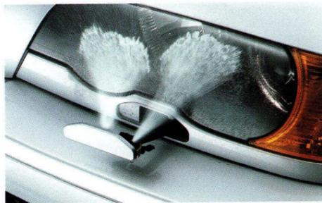
□ **Scheinwerfer-Reinigungsanlage**: Parallel zur Frontscheibe werden bei eingeschaltetem Licht über den Lenkstockhebel rechts auch die Scheinwerfergläser automatisch gereinigt.
