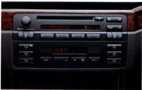
□ **BMW Business CD**, 4 x 20 Watt Verstärkerleistung. Antennen-Diversity (drei in die Heckscheibe integrierte Antennen übertragen das UKW-Radiosignal bestmöglich, ohne Knacken oder Rauschen), integrierter CD-Spieler statt Cassettenteil, Anschluss für BMW CD-Wechsler, motorischer CD-Einzug/-Ausschub.
