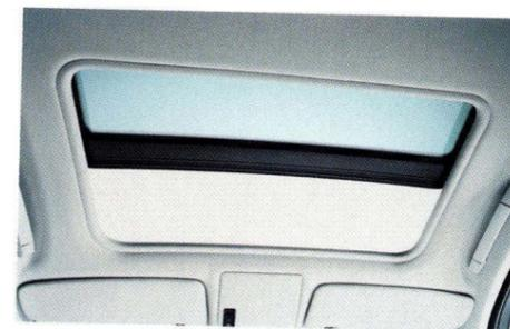
□ **Glas-Schiebe-Hebedach**, elektrisch, sorgt stets für frische Luft und beste Durchlüftung, lässt sich über einen Schalter mit Mehrfachbetätigung komfortabel öffnen, schließen oder in Hubstellung bringen.
