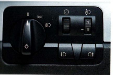
**Leuchtschaltzentrum** vereint ergonomisch die Funktionen für Stand- und Abblendlicht, Nebellichter, Nebelschlussleuchte, stufenlos einstellbare Instrumentenbeleuchtung und Leuchtmittelregulierung.
