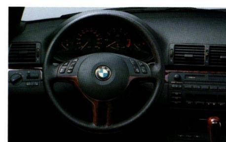
**Multifunktion für Lenkrad**, für Geschwindigkeitsregelung und Fernbedienung für Radio bzw. Telefon – hier abgebildet Sport-Lederlenkrad, drei Speichen, inkl. Lenkradspange und Wählhebelgriff in Edelholz Myrte Hochglanz ausgeführt.
