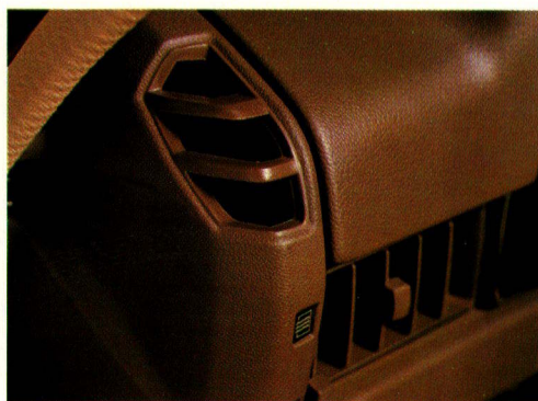
Varmluftdyser sørger for at holde sideruderne fri for dug og is.
