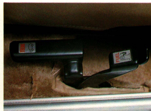
I alle modellerne kan bagagerumsklappen åbnes indefra (uden brug af nøgle). I GL modellerne kan benzindækslet også åbnes på denne måde.
