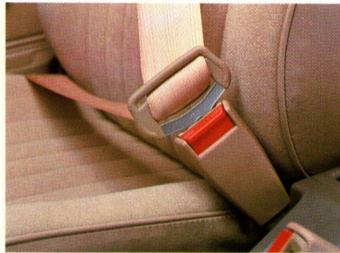
Ved forsæderne er der integrerede rulleseleer og der er forberedt for montering af sikkerhedsseleer ved bagsædet.
