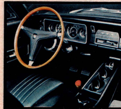
Det indre af en Ford 17M RS. Forsæderne med hvilebeslag. Instrumentering med 7 runde instrumenter
