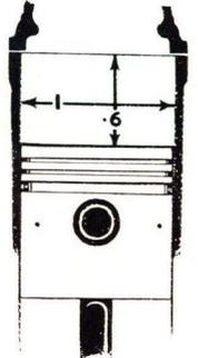
Den nye, overkvadratiske 41 hk motor giver top-ydelse med lavere benzinforbrug og mindre motorslitage. (Forholdet mellem slaglængde og boring er 0.6:1).
