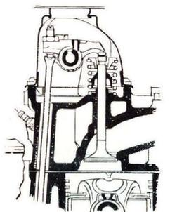
Ekstra store topventiler – med separate indgangsåbninger. Symmetrisk forbrændingskammer. Det giver blødere og mere lydløs kørsel og flere kilometer på hver benzinpåfyldning.
