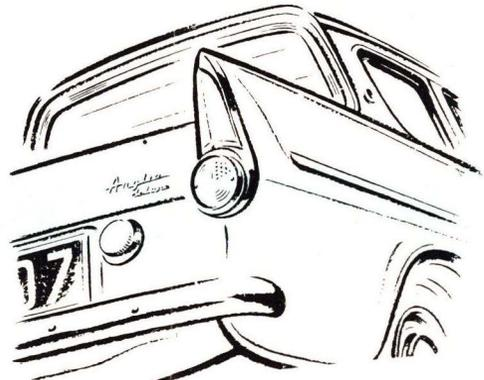
Bagagerummet er stort – både i bredde og dybde. Hver eneste del af de 0,28 m<sup>3</sup> kan udnyttes fuldt ud. Det kan nemt rumme to store kufferter og en rejsetaske – og alligevel er der plads til overs! Baglygte, stoplygte og afviserblinklys er samlet i et smukt halefinnearrangement.
