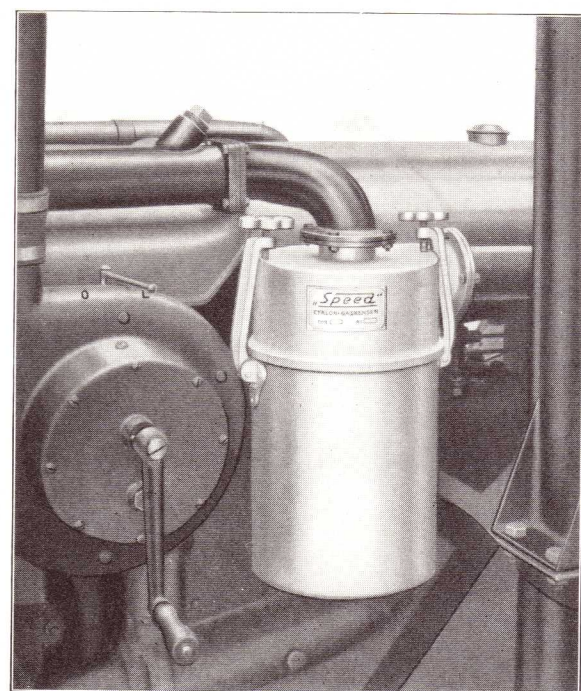
Saaledes anbringes »SPEED« Cyklonen paa en Fordson Traktor.
