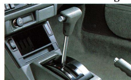
HONDA's automatiske 4-trins transmission giver et glidende gearskifte, der fungerer yderst lydløst. Brugen af momentomformer-koblingen, der overfører motorenens drejningsmoment endnu mere effektivt, medfører reduceret brændstofforbrug og gør transmissionen støjsvag.
