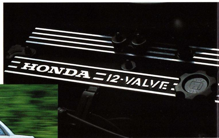
HONDA's idé med 12-ventil principippet sikrer også et roligt gennemløb i forbrændingskammeret. Resultatet er en motor med en kraft, der svarer til et 4-ventil system, men som er lige så kompakt som et 2-ventil system. HONDA ACCORD leveres med den økonomiske 1,6 liter motor eller med den mere kraftfulde 1,8 liter motor.
