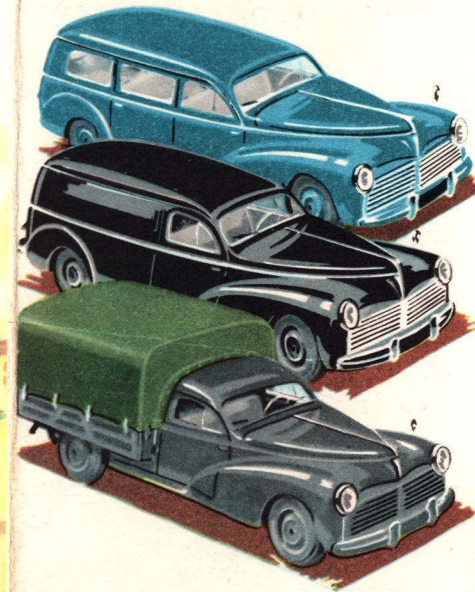
LUKKET KASSEVOGN »D4A« c. 1300 kg Fremskudt Førerhus med 2 Sæder og 2 Sidedøre. (Kan ogsaa leveres med forskydelig højre Sidedør). 2 store Bagdøre.
