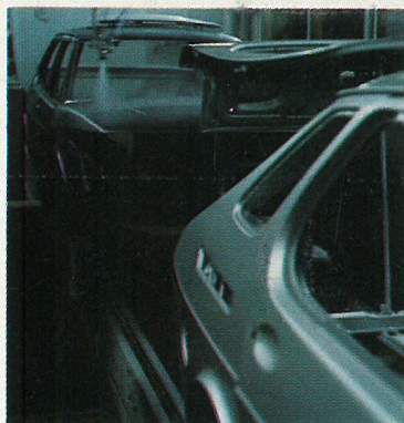
Polyesterfarve, mellemfarve og undervognsmasse sprøjtes på før hærkning i ovn.
