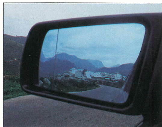
Sidespejle af vidvinkeltype. Kan indstilles indefra. El-betjente på luksus-udgaver.
