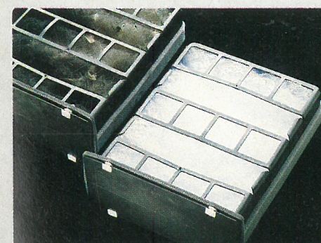
Kabineluftfiltret forhindrer effektivt støv og snavs i at trænge ind i kabinen. Beviset er det snavsede, brugte filter ved siden af det rene, ubrugte. Filtret er let at udskifte.
