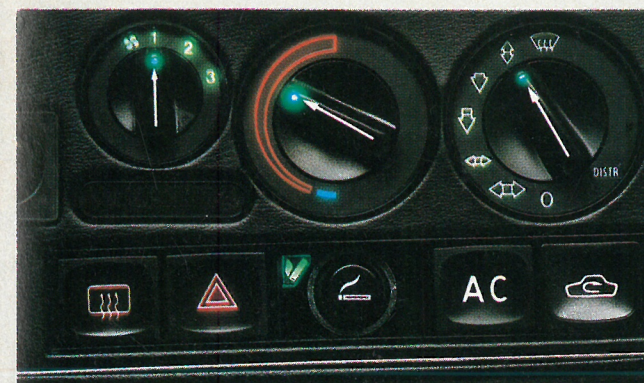
Forprogrammeret og vakuumstyret varme- og ventilationssystem. Fjerner tidskrævende finindstillinger. Luften kommer altid i rette blanding og på det sted, hvor den ønskes.
