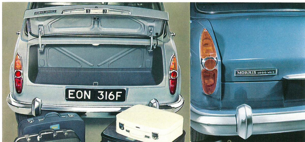
Bagagerummet er stort, det rummer en halv kubikmeter og er udstyret med lækkre måtter – har automattændende belysning, så man om aftenen kan se, hvad der foregår. Intet reservehjul, ... det er anbragt i en praktisk elevatorskuffe under vognen, og alligevel er det nemt at skifte reservehjulet. Nyt elegant baglygtearrangement med større lyseffekt og lygteoverflade. Benzinpåfyldningen er placeret bag et aflåseligt dæksel.
