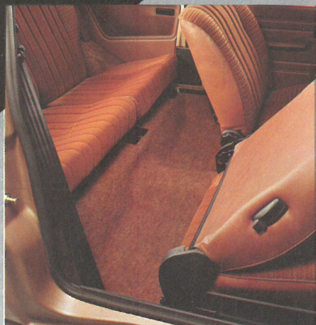
Adgangen til bagsædet kræver heller ikke akrobatiske øvelser: Forsæderne glider automatisk frem, når ryglænet lægges fremover – og dørene er tilpas brede til behagelig indstigning
