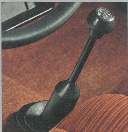
Præcist gearskift af »Remote Control«-typen
