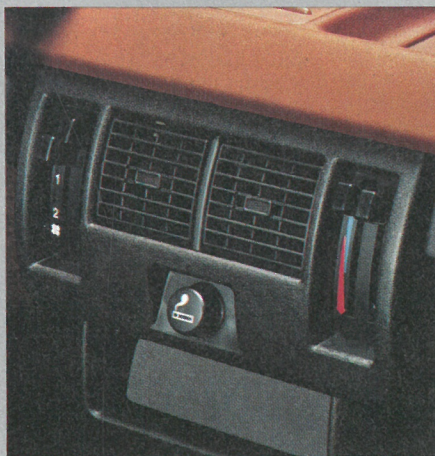
Varme- og ventilationssystem af luftblende-typen uden varmhane
