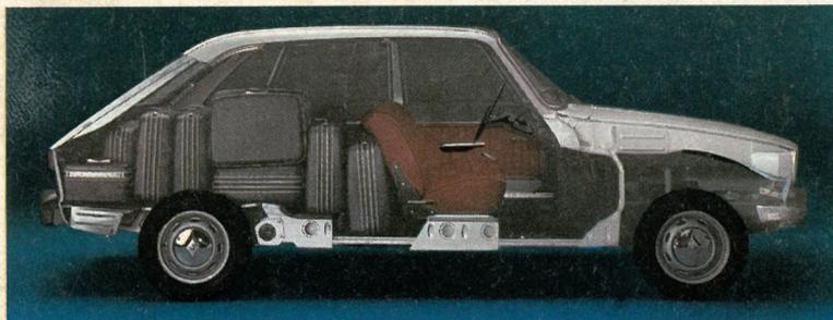
**Teknik:** Motor på 1470 cc, 63 HK. 4-trins fuldsynkroniseret gearkasse, uafhængig affjedring af alle 4 hjul (torsionsstangsaffjedring), hydrauliske bremses, skivebremser foran, tromlebremser bag, trykudligner, tandstangsstyring. 5 store døre, bagdørene sikret med børnelåse, ekstra stor dør til bagagerummet, bagsædet kan tages ud. **Mål:** Største længde: 4,231 m. Største bredde: 1,648 m.
