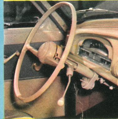
La boîte de vitesses à prise directe est très agréable à manier. En ville, la "première" est synchronisée et peut donc être passée sans difficulté après un ralentissement. Sur la route, les vitesses le plus souvent utilisées : la 3<sup>e</sup> et la 4<sup>e</sup> sont en ligne : d'où un passage rapide de l'une à l'autre, sans temps mort.
