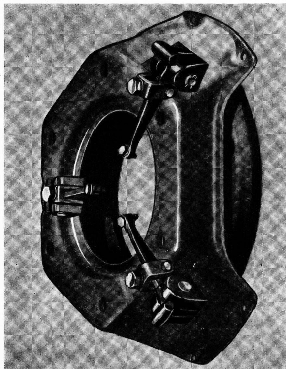
Ford Koblingen udnytter Centrifugalkraften.
