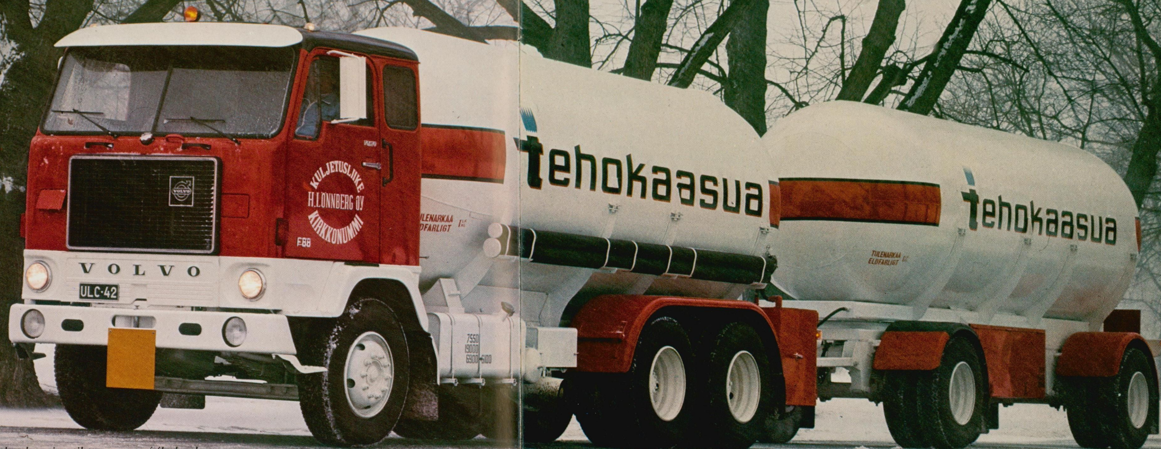
FB 88 og 2-akslet påhængsvogn med tankopbygning til transport af flydende gas.
