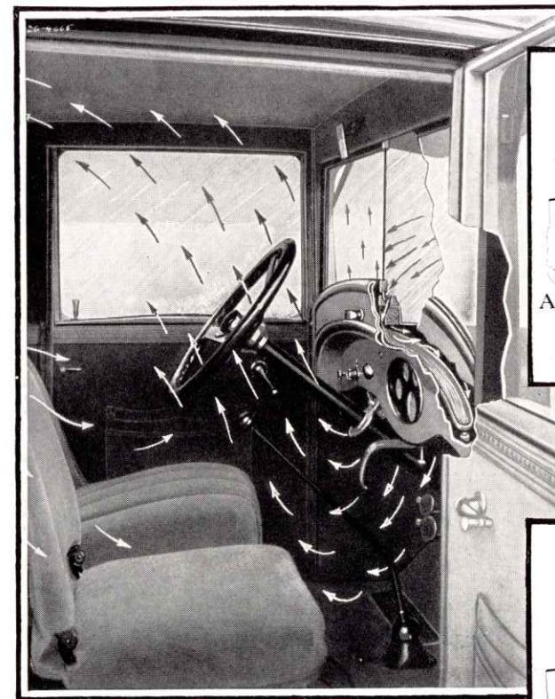
Den selvventillerende Vindskærm paa de lukkede Modeller, som ikke giver Træk, er en speciel Studebaker-Konstruktion. Den forårsager, at der altid kan være frisk Luft i Vognen, uden at der er Træk. Sindrege Kanaler under Torpedoen (som vist paa Billedet til venstre) opsamler og bortleder alt Vand, saaledes at Ventilation i det stærkeste Regnvejr er mulig.
