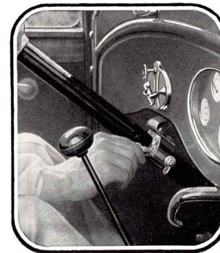
Studebakers kombinerede Tændings- og Ratlaas er anbragt paa Styrerøret, den aflaaes paa een Gang Tændingen og Rattet. Nøglen som hører hertil passer ogsaa til Dørhaasen og Reservehjulsholderen, samt paa Roadsteren, Victoria og Coupe'en til Bagrummet.
