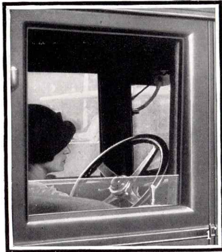
Sammenlign den svære Hjørnestolpe i Trækarosseriet (1) med den smalle Hjørnestolpe i Staalkarosseriet (2). Den sidste borttæller fuldstændigt den farlige »blinde Zone«, hvor man intet kan se for den brede gammeldags Hjørnestolpe. Staalpillen er ogsaa meget stærkere.
