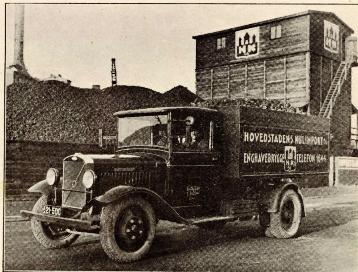
Volvo Lastautomobil LV-72 D med Karosseri for Kultransport.
