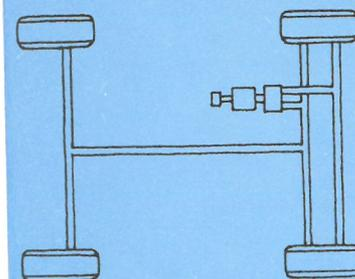
fire stempler, og begge de to kredse er ført til forhjulene. Et system, som aldrig før er set på en vogn af Metro's type - og af sparegrunde - også yderst sjældent på de større biler.
