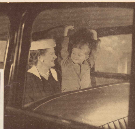
Bemærk den fine loftshøjde. Det er bemærkelsesværdigt, at en vogn, der er så velproportioneret, har en så stor loftshøjde. Dette er opnået ved anvendelse af hypoid bagaksel, der gør det muligt at sænke gulvet, uden at den frie højde over vejbanen påvirkes. Den indvendige loftbeklædning er afvaskelig.
