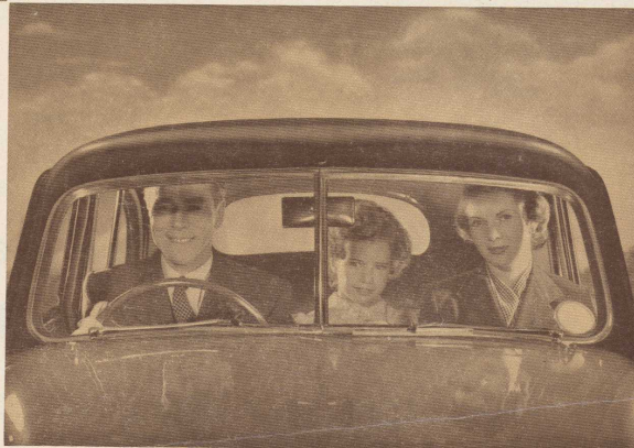
Godt udsyn giver kørselssikkerhed. De sidder godt på førersædet og har et fint udsyn gennem det brede vindspejl. Smalle hjørne- og dørstolper bevirker, at den farlige "blinde vinkel" ikke findes. Forsædet giver om fornødent plads til tre personer.
