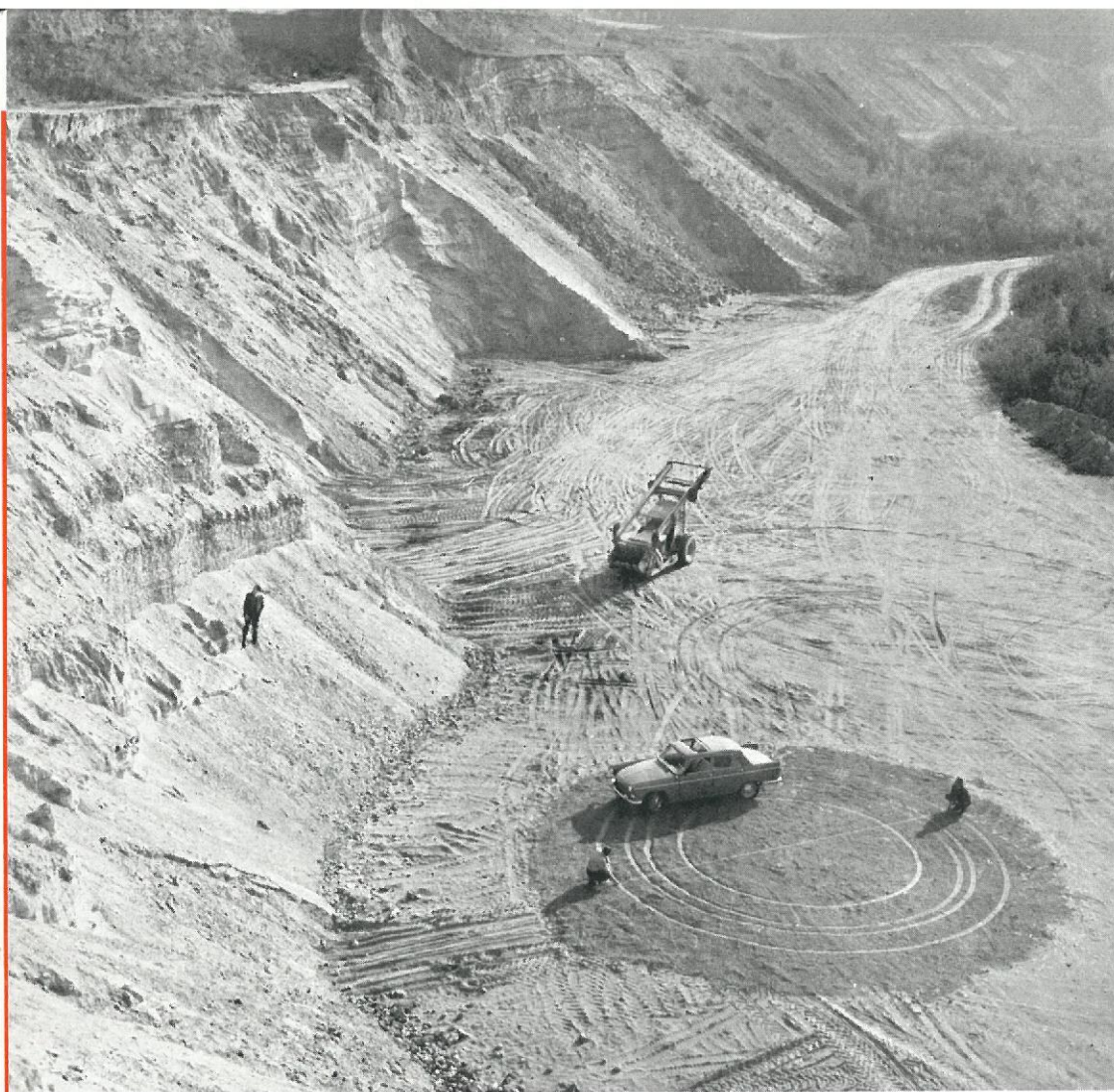
En grusgrav er ideel til måling af vendetidmeteren.
