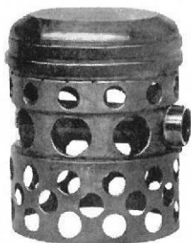
Motordele fra Sunbeam'en i Coupe de l'Auto, 1913 — et stykke af plejstangen, indsugningsmanifold og Gruyè-stempel.
