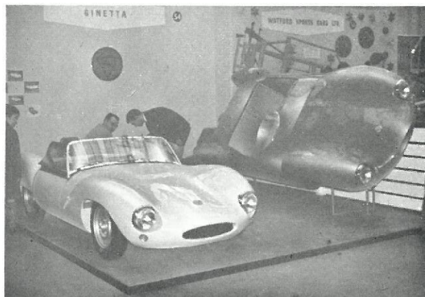
Ginetta 4 er en plastic/rørrammekonstruktion – ikke for selvbyggere, men man kan selv samle den og spare den engelske omsætningsafgift.
