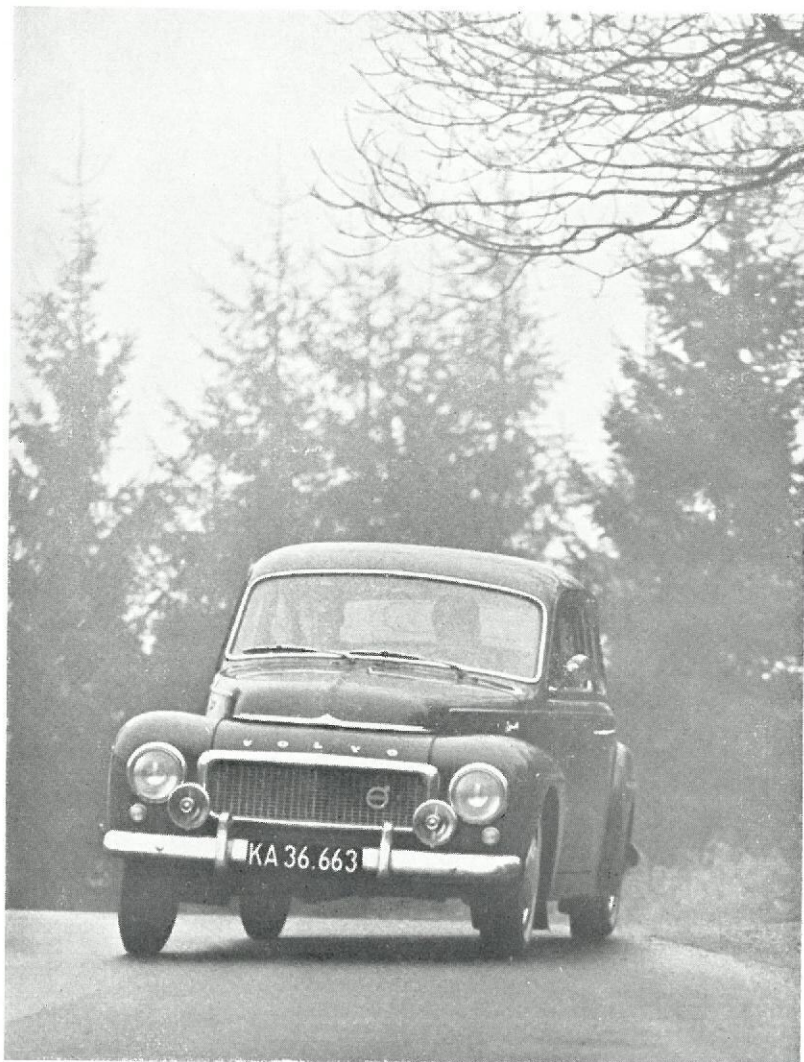
Vognens understyrende egenskaber betyder forøget sikkerhed for den øvede. Er man mindre erfaren, og undervurderer nødvendigheden af et relativt kraftigt styredslag, vil vognen let gå gennem kurven med for stor radius, som her på billedet.
