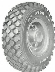
AVON 3.50-5 studded baghjul med kugle- eller rullelejenav eller med nav beregnet for anven- delse af „Live Axle“.
