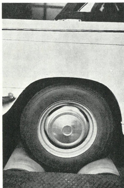
Baghjulene roterer på dynamometrets ruller med hastighed af 110 km/t. Hvis bilen kunne bevæge sig, ville den køre til højre, og bemærk, hvordan dækket deformeres under presset mod den højre rulle.
