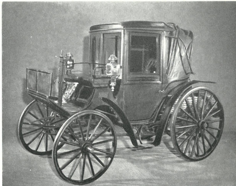
Herover en Benz Myllord coupé 1897. Den 2-cyl., 2,5 liter hæk-motor ydede 9 hk, hvilket gav motoren en marchhastighed på 40 km/t. - Det næste billede viser en fire-sædet tourer fra 1910, udstyret med en 4-cyl., 4,1 liters motor med dobbelte glideventiler fremstillet efter Knight's patent, som også anvendtes af Daimler i England.
