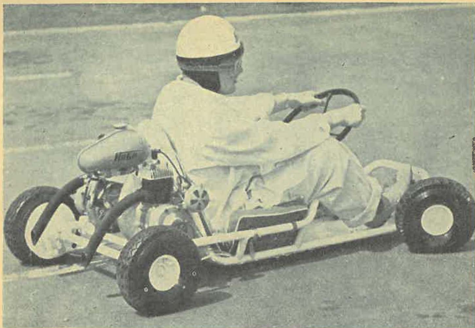
Den velkonstruerede Haka go-kart er monteret med to motorer, der er vendt mod hinanden således, at den udgående krumtapaksel i begge tilfælde vender ud mod baghjulene. Af samme grund roterer de to krumtapaksler med hver sin omdrejningsretning.
