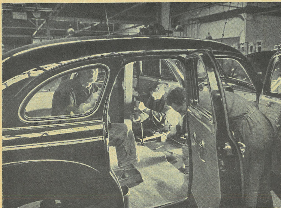
Inden fabrikkerne lægger tæppebelægning i en vogn, klistres en art gulvpap til bunden. Denne belægning kan imidlertid løsne sig med årene, og trænger der først fugt ind under en sådan belægning, vil et rustangreb ikke kunne undgås. Til en rigtig make-up må også høre fornyelse af tætningslister ved døre og vinduer.
