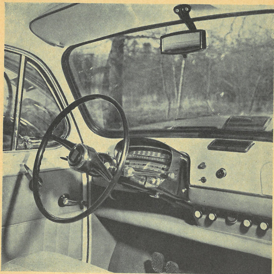
Instrumentbrættet i Fiat 1100 Export. Kontakterne sidder med så god spredning, at man kan finde dem i blinde.
