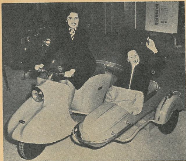
På udstillingen i London vises denne engelske scooter med letvægtssidevogn. Scooteren hedder Oscar og er monteret med en 197 ccm Villiers motor på 8,4 hk ved 4000 omdr./min. Gearkassens tre udvekslingsforhold skiftes ved hjælp af en fodpedal. Begge hjul er ophængt i swingarme, og forhjulet er affjedret ved hjælp af gummielasterelementer.
