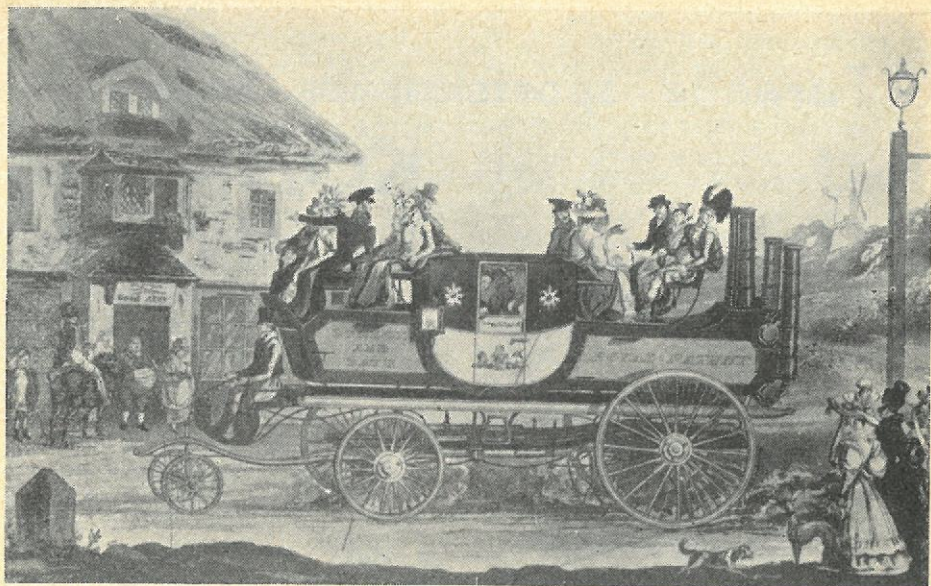
Gurney's damp-rutebil fra 1827. Baghjulene blev drevet af to vandrette cylindre, og styretøjets hovedelementer var hentet direkte fra hestevognene, men da man ikke havde heste at styre, måtte to små styrehjul besørge det store moment til de egentlige forhjuls drejning.
