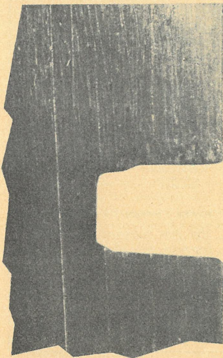
Et snit gennem stemplet viser, hvordan noten kan blive deformet af stempelringens slagagtige bevægelser op og ned. Naturligvis kan man ikke uden videre montere en ny ring i en defekt not.
