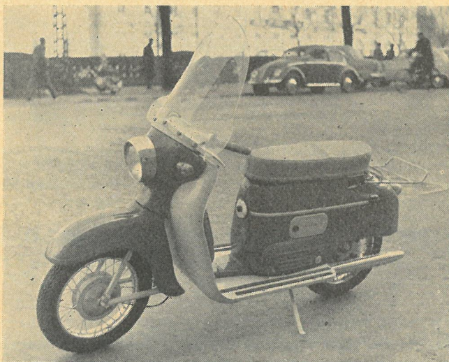
Den lille Manet er ikke meget dyrere end en knallert, og den er endda udrustet med elektrisk starter og fire-trins gearkasse. I modsætning til den oprindelige model er Manet nu forsynet med en stor, effektiv lydpotte.
