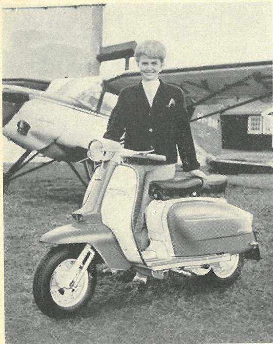
Som det ses, er skivebremserne lukket inde i hjulene, men store udskæringer giver tilstrækkelig køleluft. Forskærm og lygte er på den nye Lambretta 175 TV udformet af plastik.
