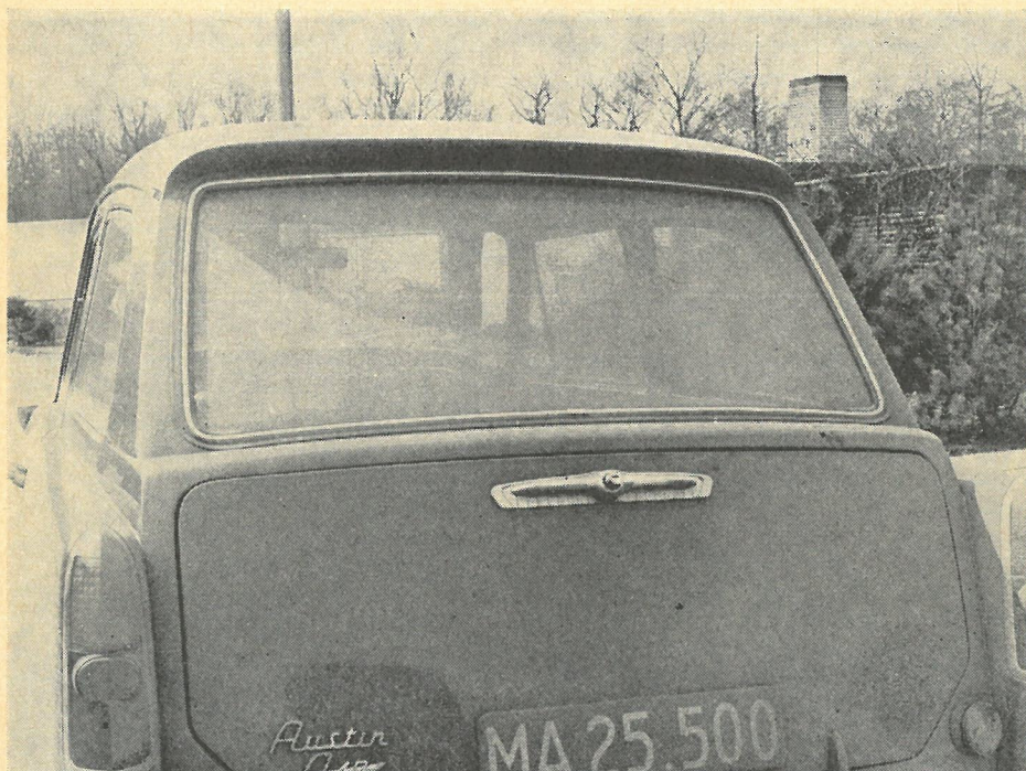
Som andre vogne med bagruden helt ude ved den bageste kofanger trækker Futura et stort hvirvelfelt op bag vognen, og i regnvejr bliver bagruden derfor belagt med vejsnavs.
