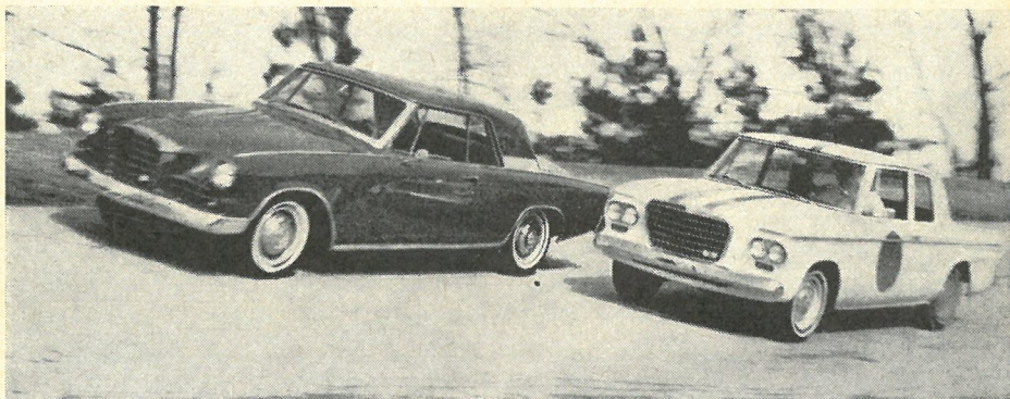
To nye Studebaker modeller er kommet på markedet. Det er Super-Lark og Super-Hawk. Begge vogne er monteret med R-2 Avanti motor med kompressor, og begge vogne er blevet noteret til en topfart på 210 km/t ved United States Auto Club's hastighedsprøver på saltsletten ved Bonneville.
