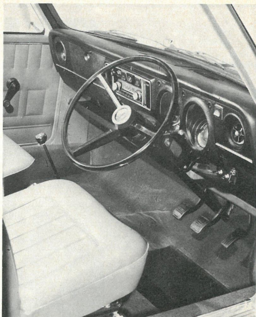
Interiøret i en højrestyret vogn. Instrumenterne er dybt nedfældet i forpanelet, og de har tillige en hældning, der giver mere præcis aflæsning.
