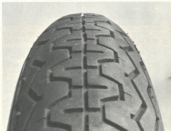
Dunlop KR 73 i oppumpet stand, dimensionen er 3.00/3.25-18". Ikke desto mindre er dækbredden på en WM2-fælg, hvis indvendige bredde er 1.85", så meget som 3.90". Dækket har således et betydeligt udhæng over fælgen, hvilket ellers bør undgås til landevejsbrug. Dækket er ikke helt triangulært. Hvis dette var tilfældet, ville det ikke kunne holde ret længe til at overføre den fulde effekt af en racermaskine ved opretkørsel. Karkassen har den form, der giver den rigtige fordeling af slidbane til akceleration og kurvekørsel på en lukket bane. Anvender man dækket på offentlig vej, vil man uundgåeligt komme til at slide midterpartiet op før siderne. Hvis man i øvrigt kører behersket i opret stilling, og kun udnytter dækkets ressourcer ved kurvekørsel, er holdbarheden ikke så ringe endda, på trods af den tynde slidbane, og man kan regne med, at dækket holder ca to trediedele af et almindeligt dæk. Fordækket er væsentligt mere trekantet, svarende til at bremsearbejdet under et racerløb trods alt er væsentligt mindre end motorarbejdet.
