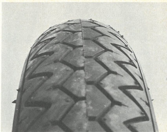
Yokohama racing Rear i profil, i oppumpet tilstand. Dækket er ikke triangulært, men er rent squatdæk. Dækket, der er 3.00-18", har godt en cm mindre rulningsradius end et normalt 3.00-18" dæk, samtidig med at det er knap en cm bredere.
