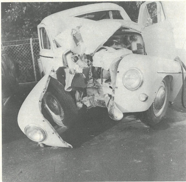
Denne vogn har haft et frontalt møde med et vejtræ, der blev stående. Det er gået hårdt ud over forhjulsophæng og styretøj. Motoren er blevet presset voldsomt ind mod forbrættet, men kabinen er praktisk taget uskadt, som det fremgår af billedet til højre.
