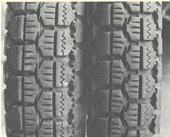
To gange Pirelli MT 53. Pirelli fremstiller et langgrillet fordæk, men det forhandles ikke her i landet. I stedet prøvede jeg at montere MT 53 på begge hjul. Om resultatet kan De læse i teksten. Mønsteret er dybt og åbent og har især sin berettigelse på dårlige veje.
