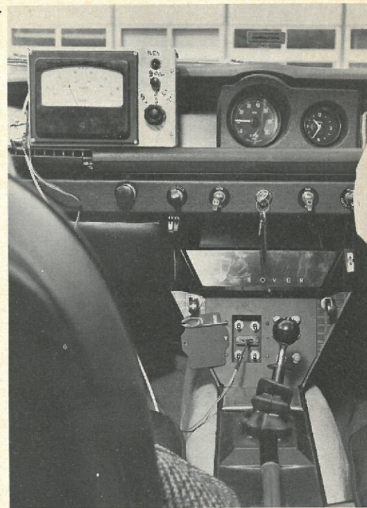
Under forsøgene på RRL's prøvebaner benyttede Mullard denne Rover 2000. Instrumentet til venstre viser hastigheden og bremselængden, medens de fire kontakter til venstre for gearstangen kan tilsluttes og afbryde anti-blokerings-systemet på hvert hjul for sig.
