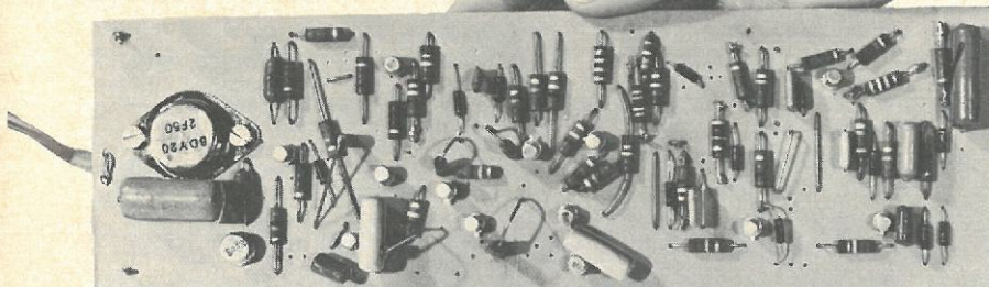
Dette eksperimentelle kredsløb benyttedes af Mullard til at styre bremseprocessen. I masseproduktion kan det hele integreres, nedfotograferes og anbringes i en tændstikæske! ▽
