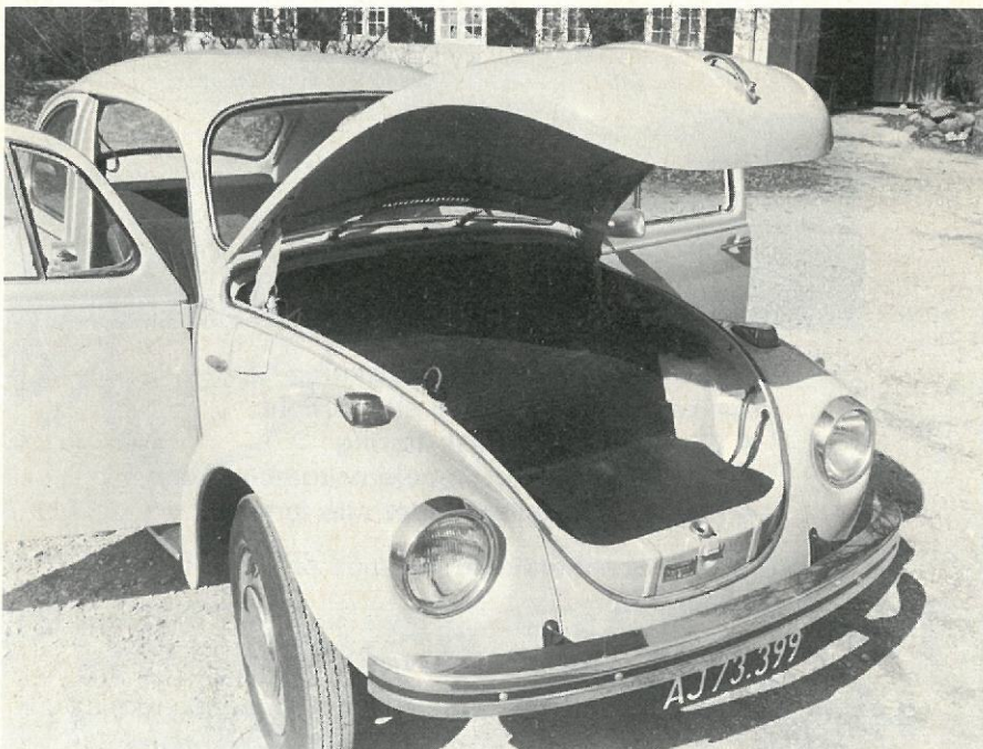
260 liters regulært udformet bagageplads er en forøgelse på 85 pct. i forhold til tidligere. Af sikkerhedshensyn ligger benzintanken nederst i rummets bagerste del.
