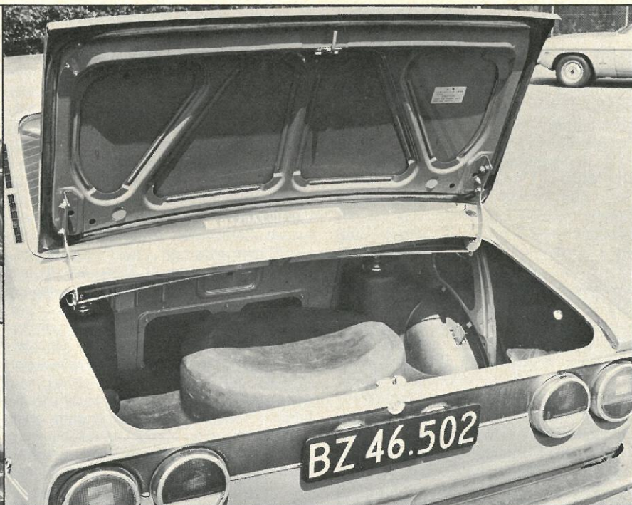
Dette er ikke transport af en parmasanost, men en noget uhensigtsmæssig anbringelse af reservehjulet i det ikke altfor store bagagerum. I øvrigt er adgangen til rummet ikke særlig nem, forkanten er ret høj og klappen ganske smal, som det sig hør og bør på en coupé-model.
