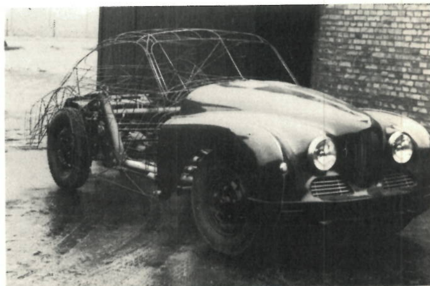
Sommers karetmagermester og sønnen Ole Sommer udkastede på fri hånd faconen på Jupiterens karrosseri i sammensvejste tynde stålstænger – under hyppige diskussioner med se
