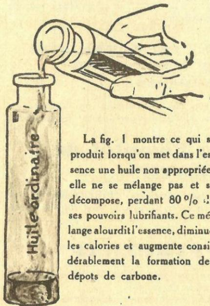
La fig. 1 montre ce qui se produit lorsqu'on met dans l'essence une huile non appropriée: elle ne se mélange pas et se décompose, perdant 80 % de ses pouvoirs lubrifiants. Ce mélange alourdit l'essence, diminue les calories et augmente considérablement la formation des dépôts de carbone.
