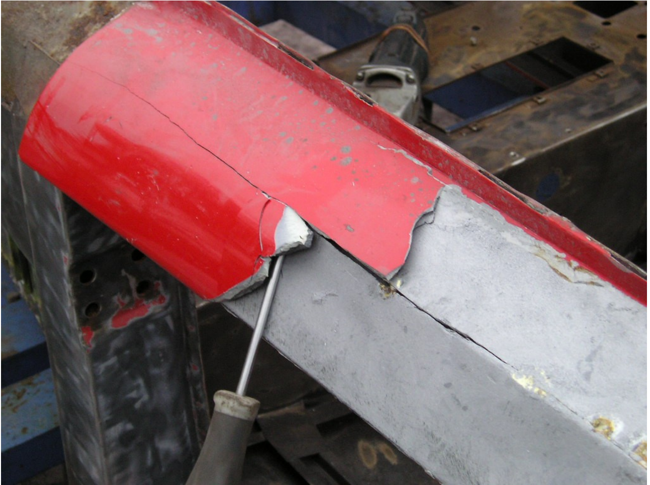
Yderpanel i galvaniseret plade og et tykt lag armeret padding
