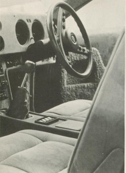
Ein Mittelwellen/UKW-Radio, eine 8-Spur-Stereoanlage, die Bedienung für die Vollklimaanlage und Schalter für die vollautomatische Betätigung der Seitenscheiben sind in der Mittelkonsole eingelassen.
