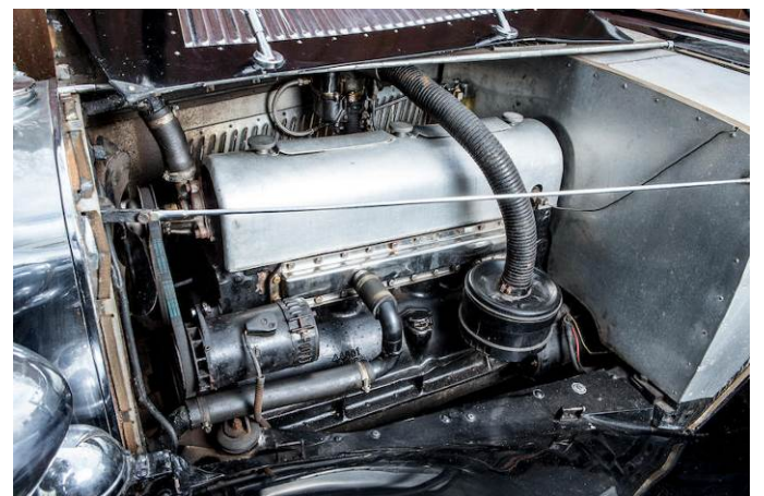
Det mærkelige låg oven på motoren må være Brough's egen opfindelse. Sådan et havde Terraplane-motorerne normalt ikke.
