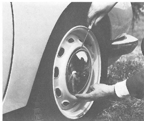
Fig. 30 Demontering af hjulkapsel
