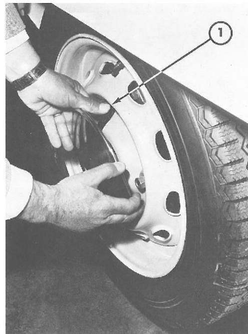
Fig. 31 Montering af hjulkapsel 1. Holdefjeder for hjulkapsel
