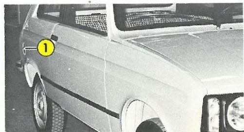
FIG 7: Påfyldning for benzintank 1 - Dæksel
