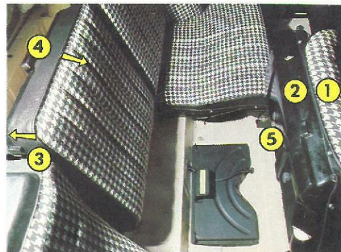
FIG 12 - Bagsæder 1 - Forsæderyglæn 2 - Sædet på bagsæde klappet sammen 3 - Låsehåndtag 4 - Holder 5 - Hak for holder
