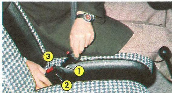
FIG 16 - Sikkerhedsseler 1 - Låsepal 2 - Låsegreb 3 - Udløsergreb
