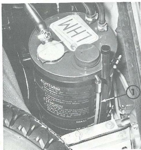
Fig. 26 – Hydraulikvædsketank 1 – Gennemsigtigt niveaurør
