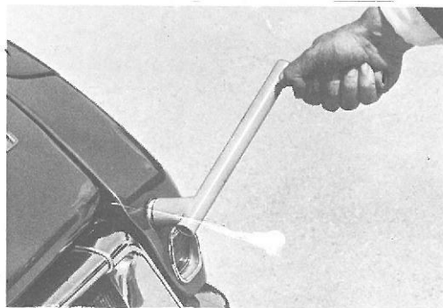
Fig. 32 - Demontering af bagskærm
