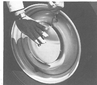
Fig. 33 bis - Demontering af lille navkapsel
