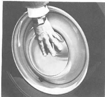
Fig 36 bis – Montering af lille navkapsel
