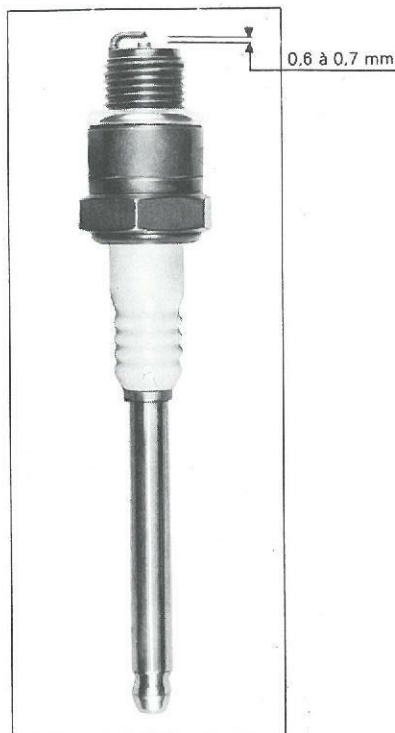
Fig. 48 - Elektrodeafstand
